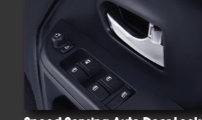
Speed Sensing Auto Door Lock Sistem akan memastikan pintu terkunci sehingga aman.
